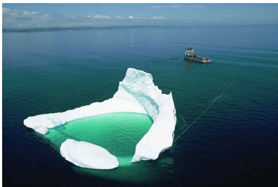
Randy Olson, Remorquage d'un iceberg hors d'une trajectoire de collision menaçant la plateforme pétrolière Hibernia, Terre-Neuve (2005) Tiré de la base de données National Geographic Creative Image numérique | 4000 x 2667 px Avec l'aimable permission du Centre canadien d'architecture
